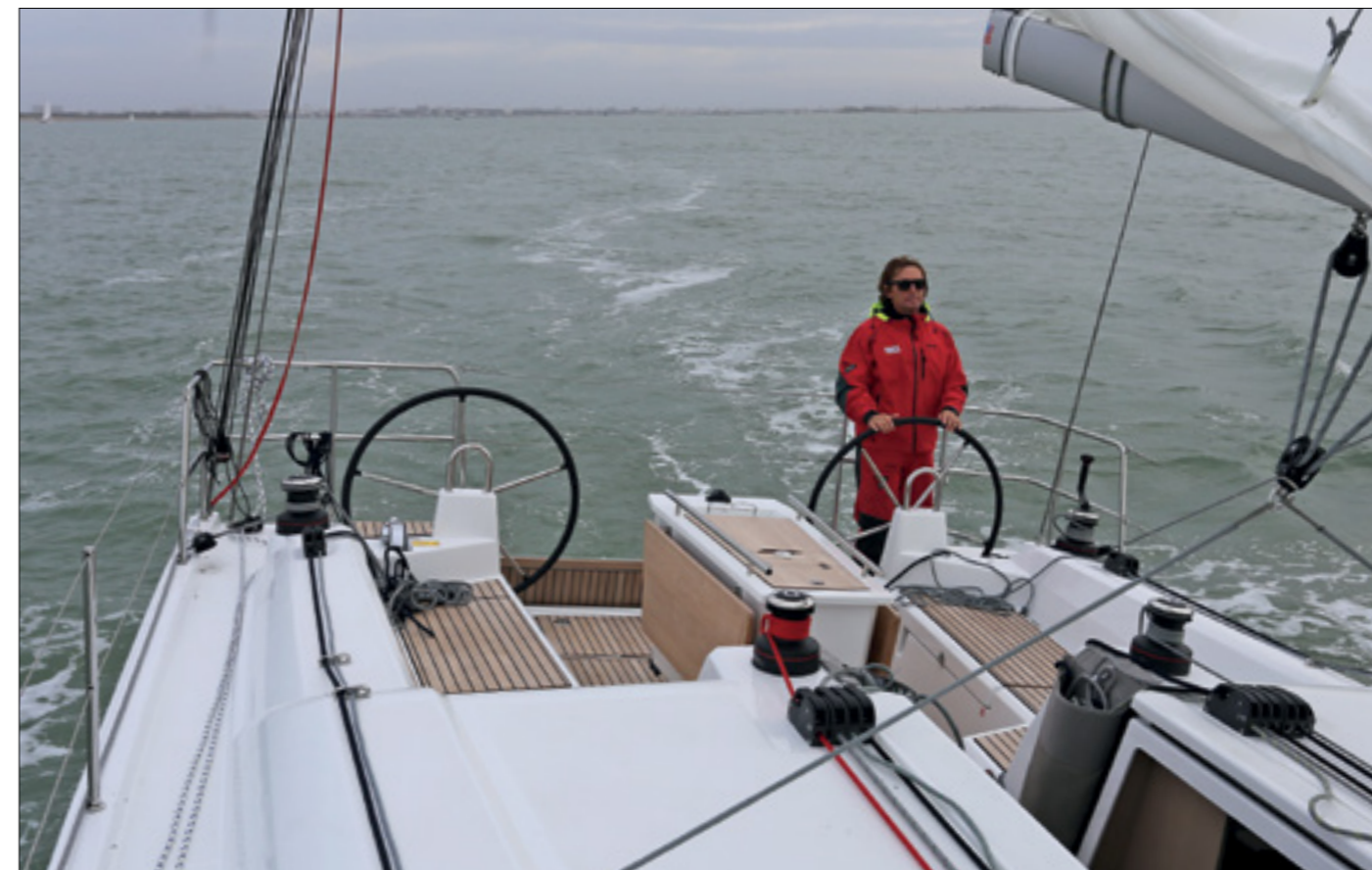
Arbeitsteilung. Beneteau gruppiert die segelrelevanten Einrichtungen um die Räder und den Niedergang. Beim Testschiff wurde die Genua über die achteren Winschen gefahren, die Großschot über die Winschen beim Niedergang. Ein German-Main-Sheeting-System gibt es als Option
