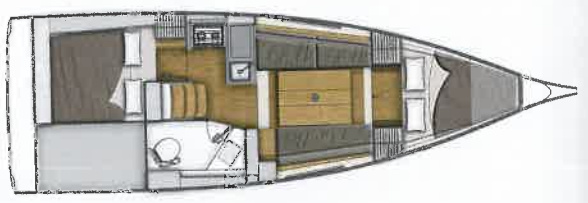
Überraschend viel. Die Doppelkabinen lassen sich mit Türen separieren. Auffällig großzügig gestaltet ist die Nasszelle. Und das lange Sofa kann auch als Koje dienen
